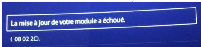
Le module s'arrêtera de désembrouiller. Il est nécessaire d'extraire et de réinsérer le module du TV avec reprise de la séquence de mise à jour depuis une chaîne comme « France 2 »
