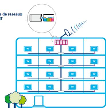
toutes les chaînes gratuites de la TNT ainsi que la chaîne France 3 régionale et/ou une chaîne de TNT locale. La solution consiste en l'installation d'une station de traitement satellite labellisée FRANSAT PRO, qui reçoit et distribue dans l'immeuble, les chaînes gratuites de la TNT au format TNT Hertzien.
